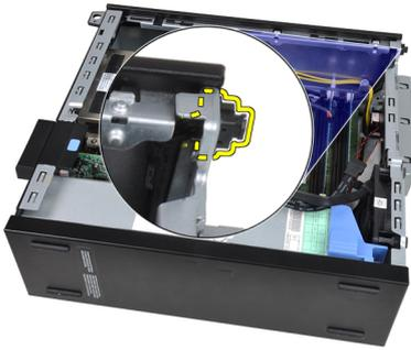
8. Schieben Sie das Betriebsschalterkabel durch die Vorderseite aus dem Computer heraus.
