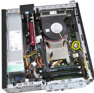
7. Lösen Sie das 4-polige Stromversorgungskabel aus den Gehäuseklammern.
