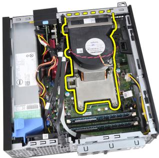
9. Drücken Sie den Entriegelungshebel herunter und bewegen Sie ihn dann nach außen, um ihn von dem Rückhalteheken zu lösen, der ihn sichert.
