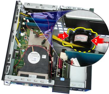
8. Entfernen Sie den Lautsprecher aus dem Gehäuse.
