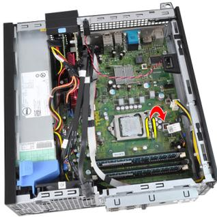
11. Heben Sie den Prozessor an, um ihn vom Sockel zu entfernen und legen Sie ihn in eine antistatische Verpackung.
