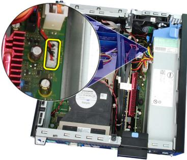
6. Lösen Sie das Lautsprecherkabel aus der Lüfterschutzklammer.
