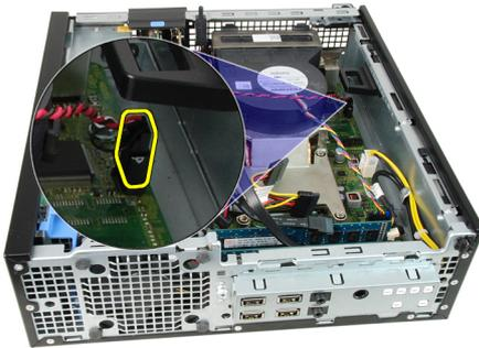
4. Schieben Sie den Eingriffschalter nach innen und entfernen Sie ihn von der Systemplatine.
