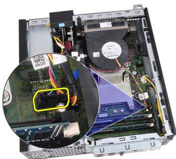
6. Lösen Sie das Kabel der Eingabe/Ausgabe-Platine bzw. das FlyWire-Kabel aus dem Kabelführungskanal am Kühlkörper.
