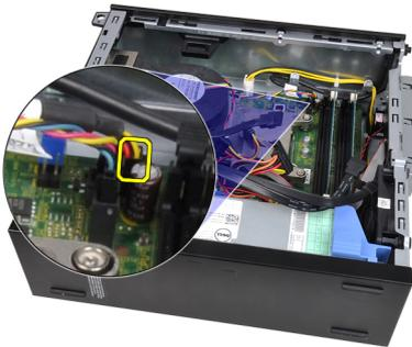
6. Lösen Sie das Betriebsschalterkabel aus der Gehäuseklammer.
