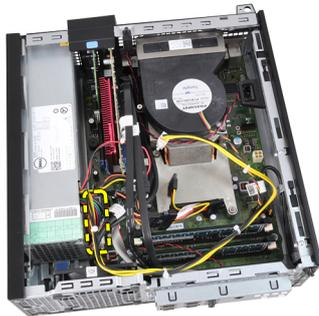
9. Entfernen Sie die Schrauben von der Rückseite des Computers, die das Netzteil sichern.
