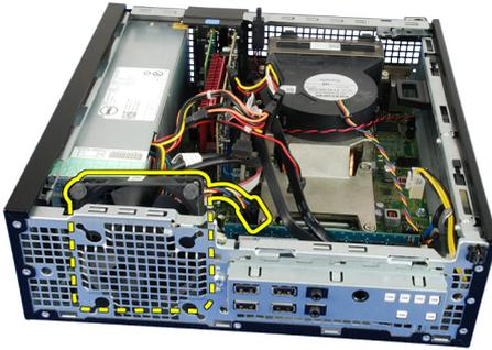
9. Hebeln Sie die Gummiösen vom Systemlüfter weg und entfernen Sie ihn.
