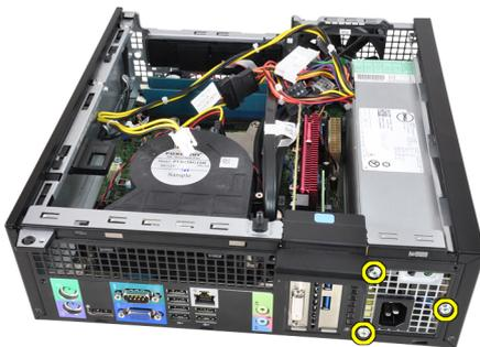
10. Drücken Sie auf die blaue Freigabelasche neben dem Netzteil und schieben Sie das Netzteil in Richtung der Computervorderseite.
