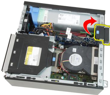
5. Drücken Sie den Entriegelungshebel von der PCIe x16-Karte weg, bis Sie die Sicherungslasche von der Einbuchtung in der Karte lösen. Dann ziehen Sie die Karte vorsichtig nach oben und aus ihrem Anschluss und entfernen sie aus dem Computer.
