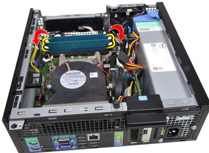
6. Heben Sie die Speichermodule aus den Anschlüssen auf der Systemplatine.
