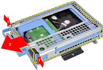
5. Biegen Sie die Festplattenlaufwerkhalterung und entfernen Sie das einzelne 3,5 Zoll-Festplattenlaufwerk oder zwei 2,5 Zoll-Festplattenlaufwerke aus der Halterung.
