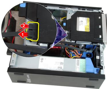
5. Schieben Sie den Laufwerkträgergriff in Richtung Computerrückseite in entriegelte Position.
