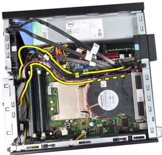
6. Trennen Sie die E/A-Leiste oder das FlyWire-Kabel von der Systemplatine.
