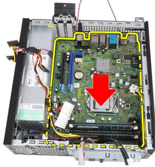
**13.** Entfernen Sie die Systemplatine aus dem Gehäuse.
