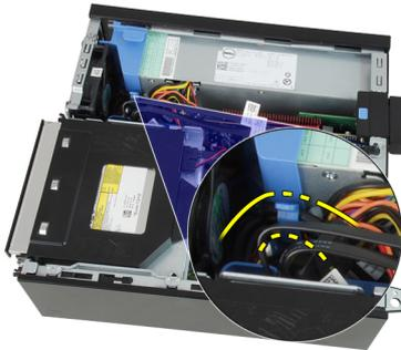
4. Heben Sie den Lüfterschutz aus dem Computer.
