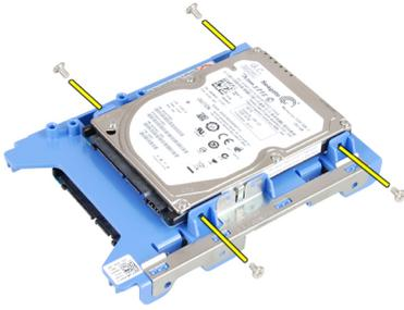
7. Lösen Sie die vier Schrauben, mit denen die 2,5 Zoll-Festplatte an der Unterseite der Festplattenlaufwerkhalterung befestigt ist.
